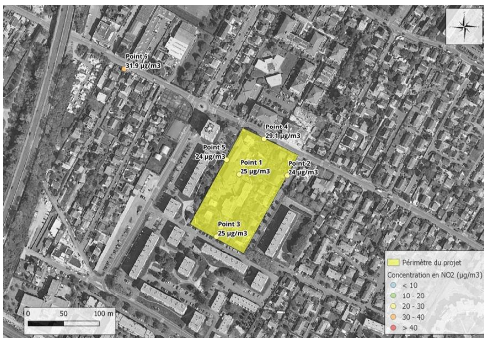
Figure 19 : Cartographie des concentrations moyennes en dioxyde d'azote sur chaque point de mesure du 4 au 18 décembre 2023
